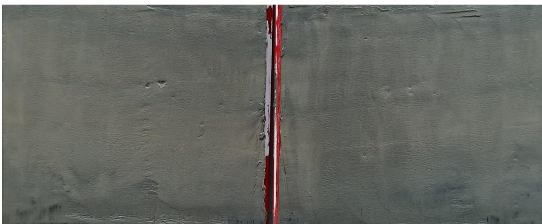
Figur 3 Borrpunkten, 23B01, 10,0 m, Jordprovet i nedre delen av mellanhylsan delad longitudinellt provhylsan med id Bjerking 755.
