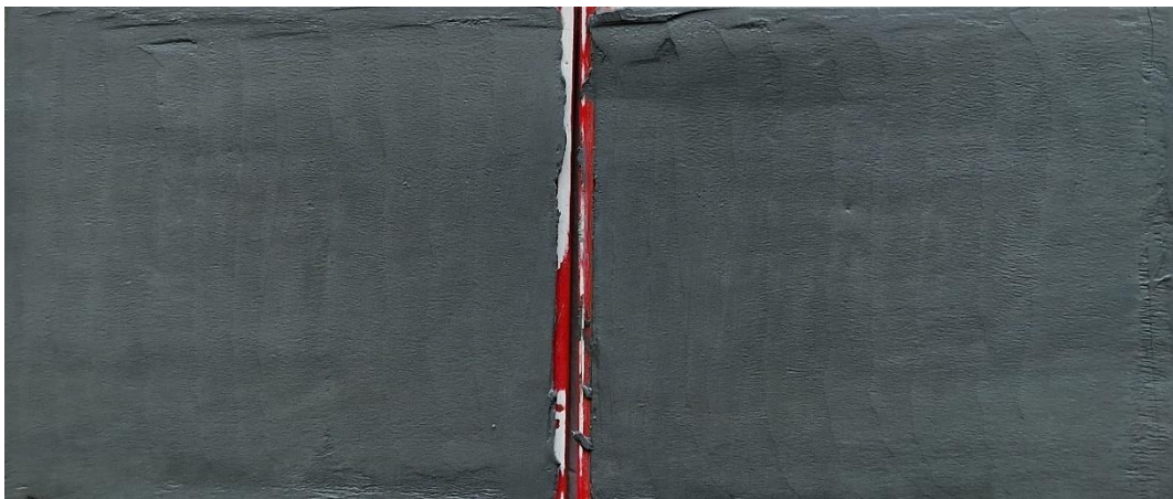
Figur 6 Borrpunkten, 23B07, 7,0 m, Jordprovet i nedre delen av mellanhylsan delad longitudinellt provhylsan med id Bjerking 897.
