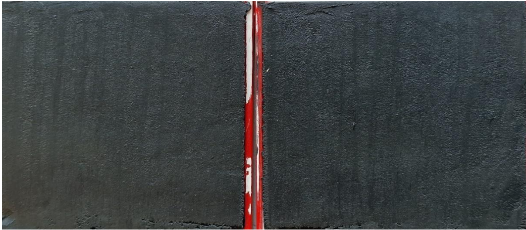
Figur 4 Borrpunkten, 23B07, 2,5 m, Jordprovet i nedre delen av mellanhylsan delad longitudinellt provhylsan med id Bjerking 858.
