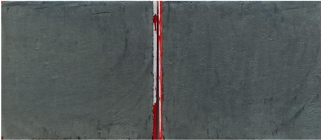
Figur 5 Borrpunkten, 23B07, 5,5 m, Jordprovet i nedre delen av mellanhylsan delad longitudinellt provhylsan med id Bjerking 877.
