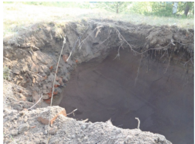
Foto 4. PG 8 – avfall ned till 1 m, orörd jord (sand) under
