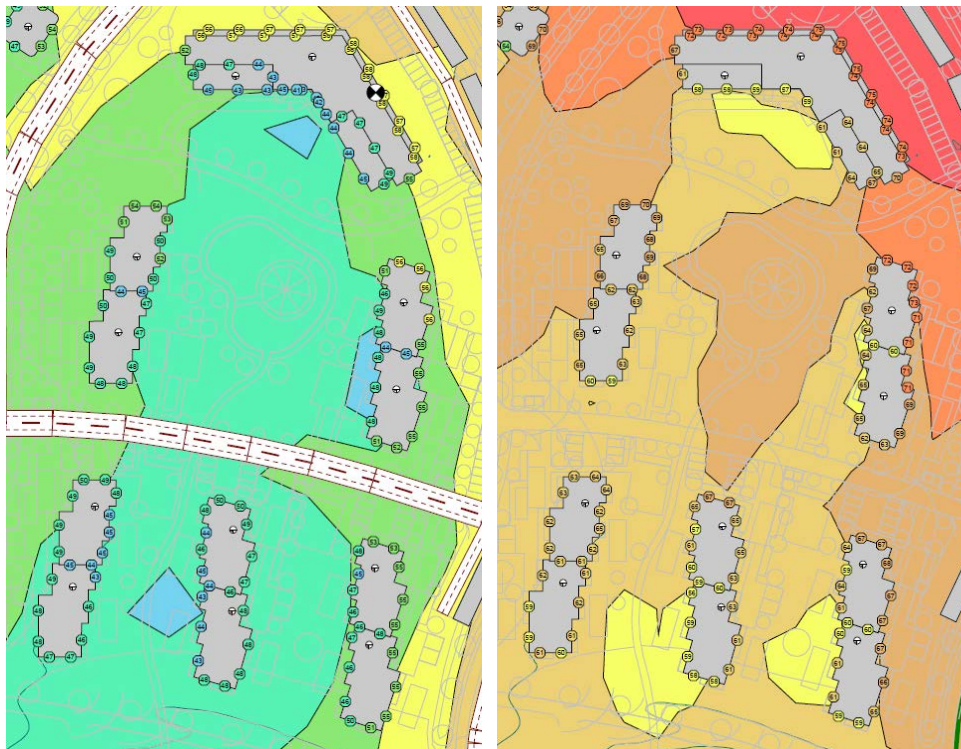
Figur 2. Ekvivalent ljudnivå (höger) och maximal ljudnivå från pendeltåg (vänster). Gemensamma uteplatser ska förläggas inom det ljusgröna området. Görs det uppfylls riktvärdena med avseende på både ekvivalent och maximal ljudnivå för uteplatser.
